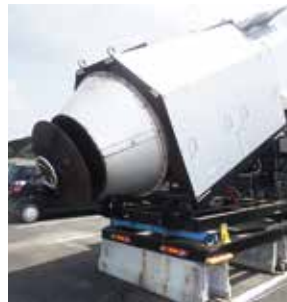
③ダンプアップ機能を搭載 加熱ドラムをダンプアップすることで最適な温度で迅速な排出が可能。
