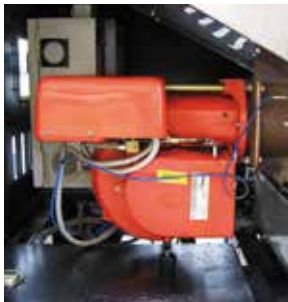
①バーナーによりドラム内を加熱 バーナーからの炎が投入材料に直接触れないように配置しました。
