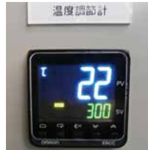
④ドラム内の温度調節も可能 温度調節計により外気温や投入材料の含水比などさまざまな自然条件に対応可能です。
